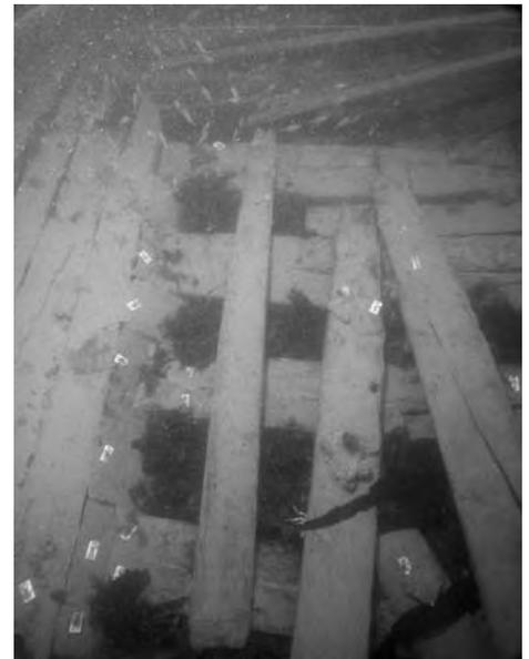
Fig. 158. Lumières sur le vaigrage et maille dans la membrure dans le flanc tribord de l'épave.
