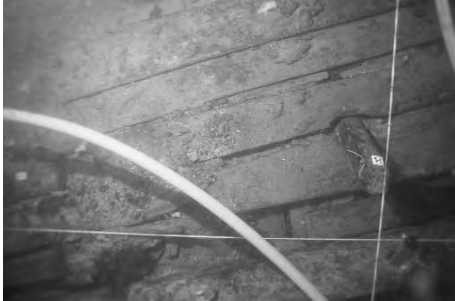
Fig. 144. Vaigrage et épointille en H22. (photo T. Seguin)
