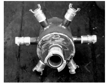
Satellite distributeur immergé permettant d'alimenter six suceuses.
